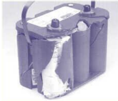
Batería que sufrió una rotura por caída y requiere un mantenimiento correctivo.
